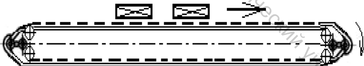
Рисунок 1.2 – Схема вертикально-замкнутого конвейера
