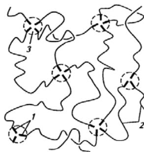
Рисунок 4.13 – Схематичное изображение структуры ТЭП: 1 – жесткие термопластичные блоки; 2 – гибкие эластомерные блоки; 3 – термопластичные домены
