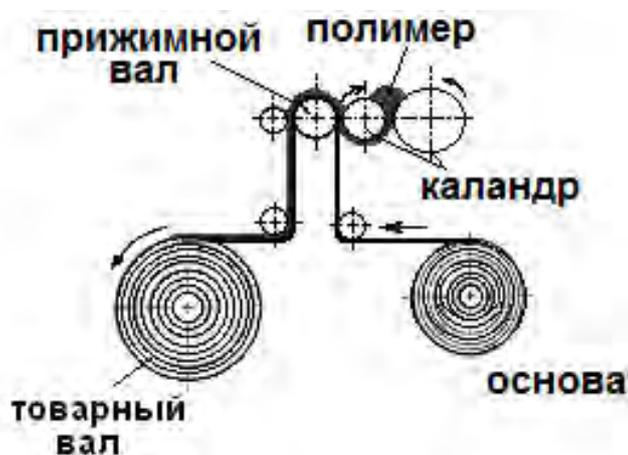
Рисунок 2.4 – Схема производства искусственной кожи кашировальным способом
