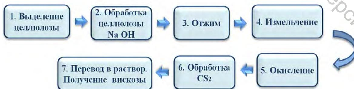
Рисунок 1.14 – Схема технологического процесса производства вискозы
