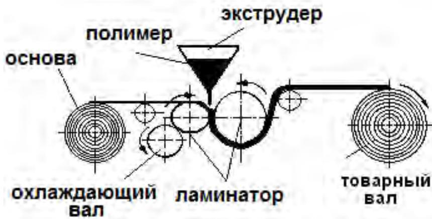
Рисунок 2.6 – Схема производства искусственной кожи способом ламинирования
