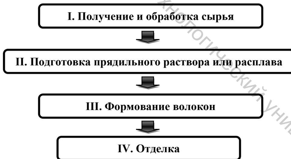
Рисунок 1.11 – Общая схема производства химических волокон
