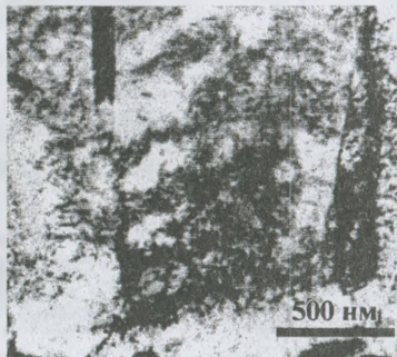
Рис.3. Периодический дифракционный контраст в пакетах мартенсита вблизи границ.
