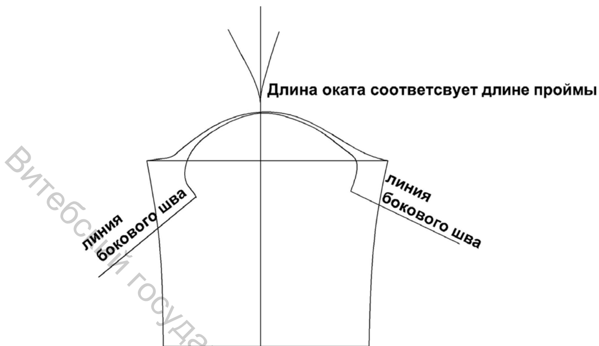
Рисунок 5.4 – Схема построения рукава рубашечного покроя методом пристраивания
