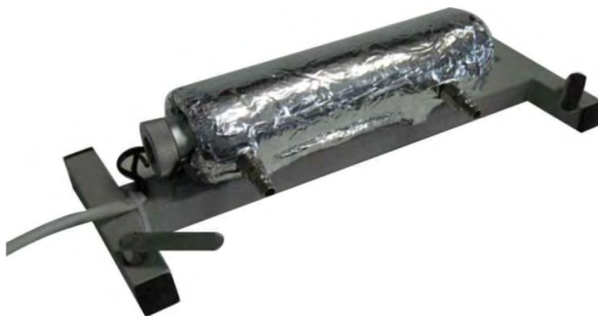
Рисунок 5.1 – Модуль НТЦ-22.05.1/6 «Определение коэффициента излучения электропроводящих материалов калориметрическим методом»
