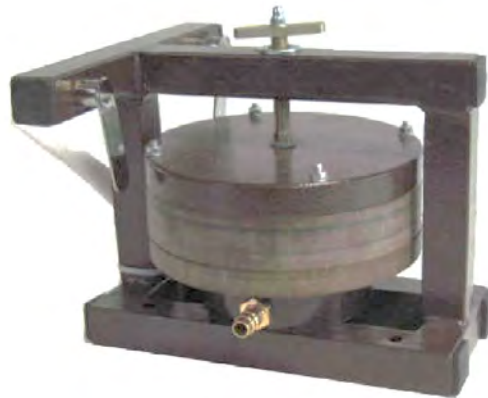
Рисунок 1.2 – Модуль НТЦ-22.05.1/1 «Исследование теплопроводности материалов методом пластины»
