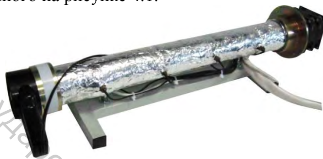
Рисунок 4.1 – Модуль НТЦ-22.05.1/4 «Исследование теплопередачи при вынужденном движении воздуха в трубе»
