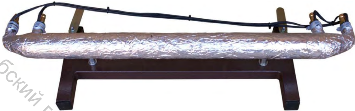
Рисунок 6.1 – Модуль НТЦ-22.05.1/7 «Исследование теплового процесса в теплообменном аппарате типа «труба в трубе»»
