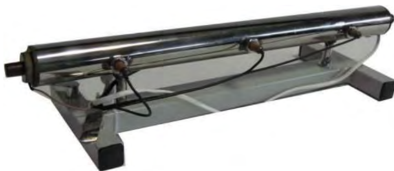
Рисунок 2.1 – Модуль НТЦ-22.05.1/3 «Исследование теплопередачи при естественной конвекции воздуха около горизонтального цилиндра»
