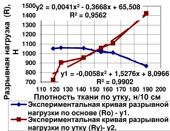
Рисунок 12. – Графики зависимости разрывных нагрузок от плотности ткани по утку
