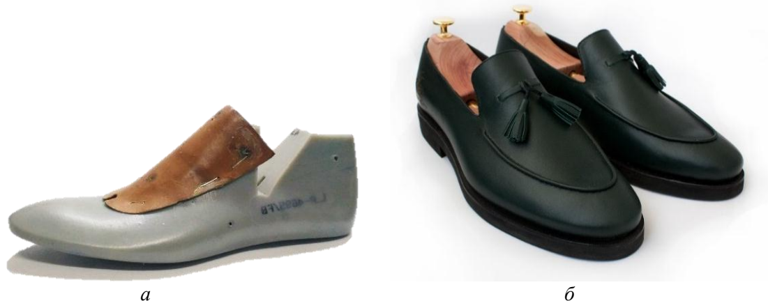
Рисунок 2 – Откорректированная с учетом субъективных ощущений комфортности потребителя колодка (а), и модель мужских полуботинок «лоферы» (б)
