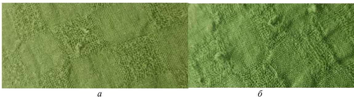
Рисунок 2 – Фото льняных и конопляных тканей после 2000 циклов: а) конопляная ткань, б) льняная ткань
