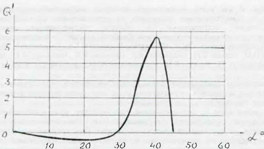
Рисунок 3 - График изменения аналога окружной силы  $Q'$  в зацеплении в зависимости от угла поворота  $\alpha^\circ$  водила
