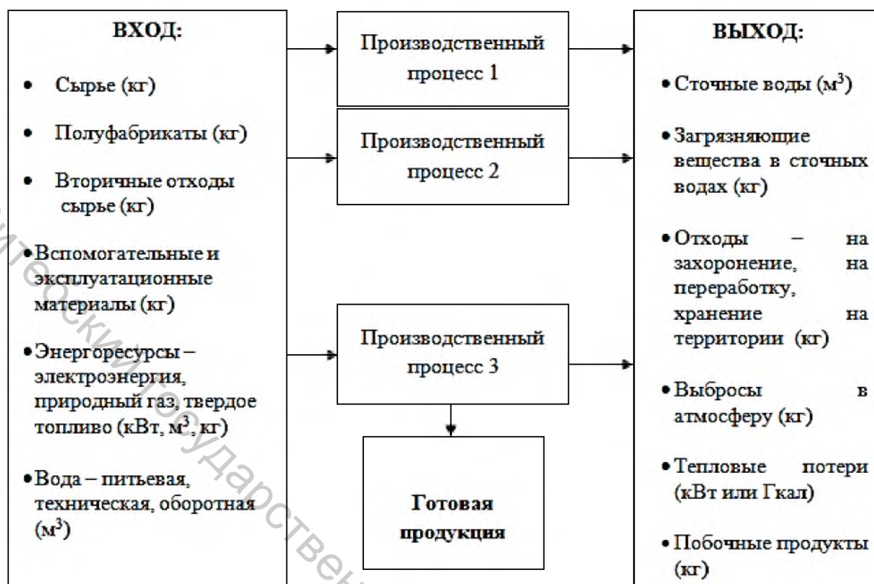
Рисунок 2.1 – Материальные потоки и экологические аспекты машиностроительного производства
