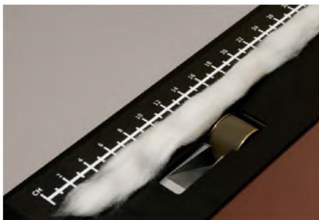
Рисунок 5.7 – Формирование ленточки требуемой длины
