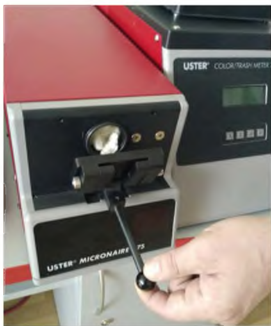
Рисунок 3.4 – Испытания хлопкового волокна на приборе Micronaire 775
