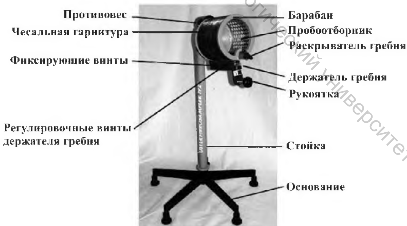
Рисунок 2.6 – Основные элементы фибросемплера
