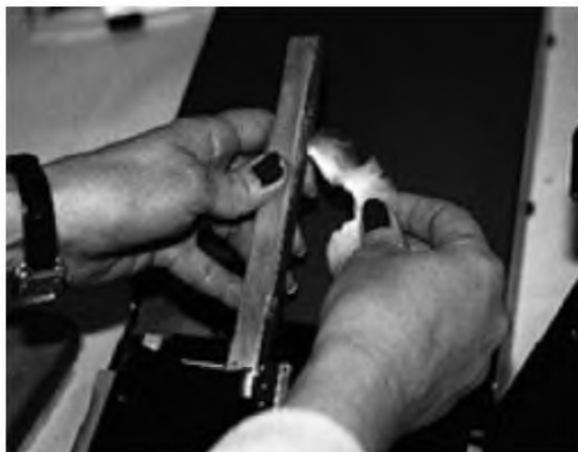
Рисунок 2.26 – Удаление излишков волокон со щетки
