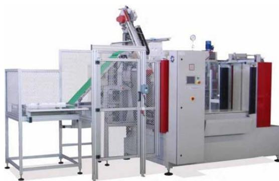
Рисунок 3 – Формовочный агрегат типа Т-20 фирмы AUTOTEX (Италия)
