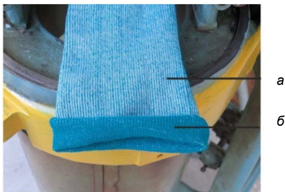
Рисунок 3 – Вид полученного трикотажа: а – лицевая сторона трикотажа, б – изнаночная сторона трикотажа
