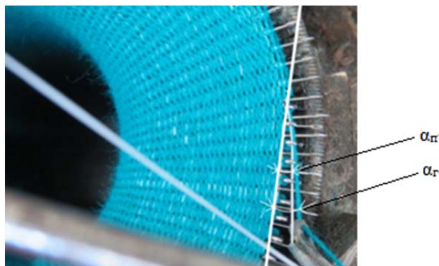
Рисунок 2 – Подача нитей под разными игольными углами на кругловязальной машине малого диаметра
