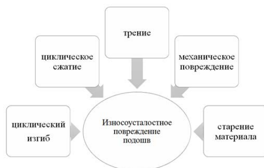
Рисунок 2 – Составляющие износоусталостного повреждения
