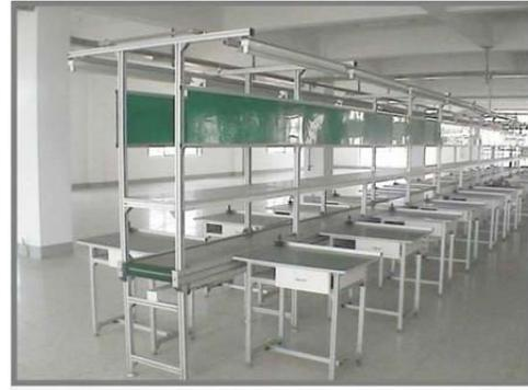
б – ленточный конвейер-транспортер для обувного производства
