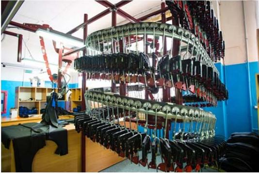
а – цепной конвейер-накопитель для швейного производства
