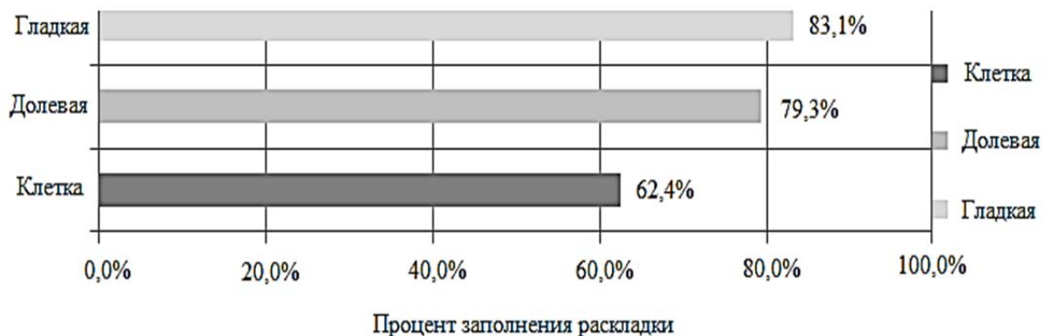
Рисунок 1 – Диаграмма эффективности раскладки с разной структурой лицевой поверхности
