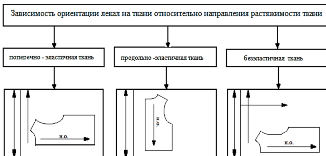
Рисунок 3 – Схема ориентации лекала относительно направления растяжимости материала
