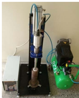
Рисунок 1 – Схема ввода ультразвуковых колебаний в кристаллизующий расплав (а) и вид экспериментальной установки (б): 1 – расплав, 2 – кокиль, 3 – стакан, 4 – основание, 5 – пневмоцилиндр, 6 – стойка, 7 – механизм перемещения, 8 – пьезоэлектрический преобразователь, 9 – бустер, 10 – излучатель
