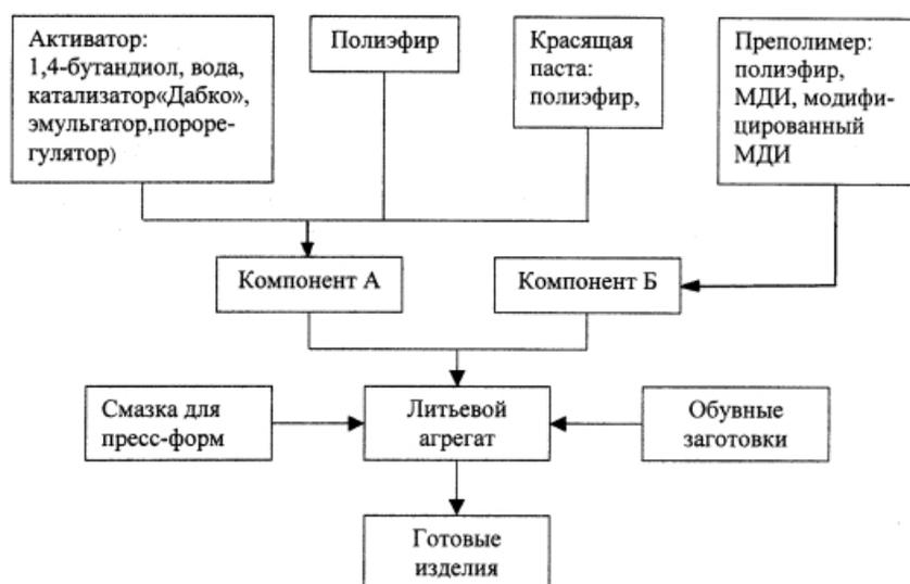
Рис.1.7. Схема технологического процесса жидкого формования пенополиуретановой композиции на агрегате «Десма 1511/18»
