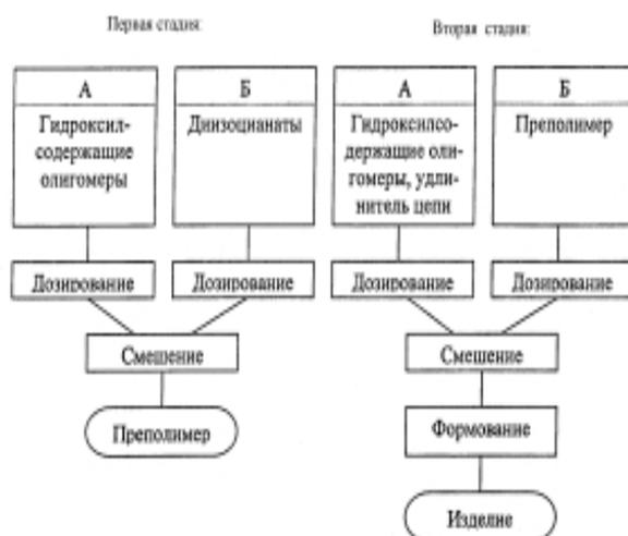
Рис. 1.6. Схема получения полиуретана двухстадийным методом
