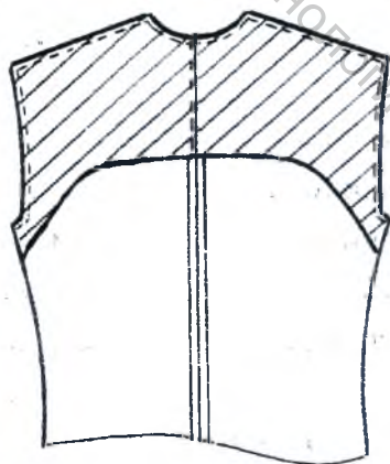
Рисунок 2.4 - Расположение прокладок в плечевом поясе спинки.
