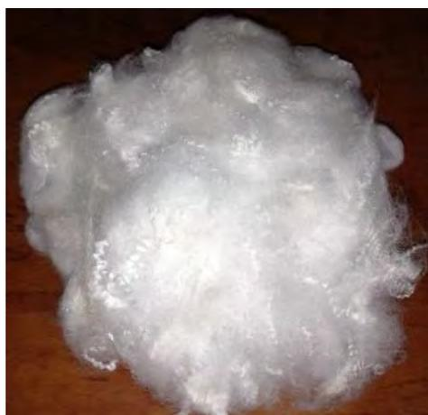
Рисунок 2.24 – Полиэфирное бикомпонентное волокно марки 4DE51Слон (производство Корея)
