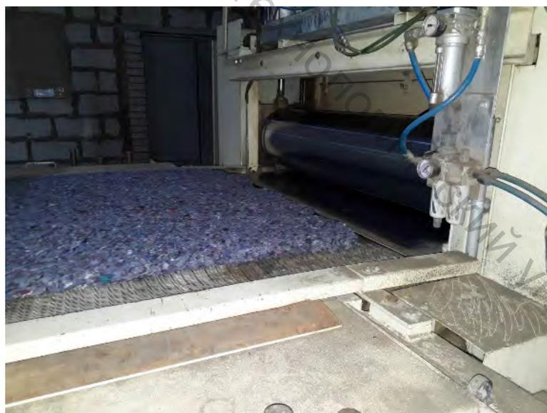
Рисунок 2.33 – Секция охлаждения и ламинирования
