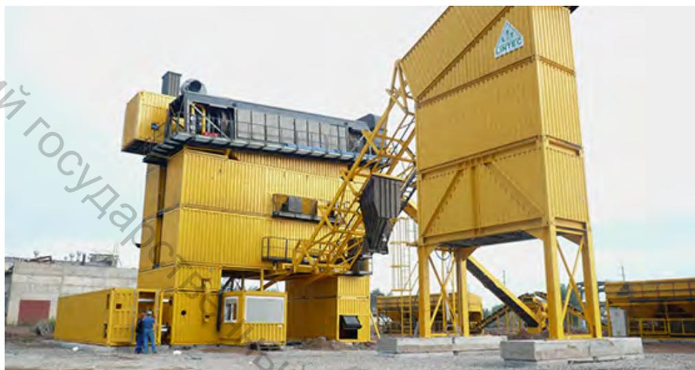
Рисунок 4.2 – Асфальтосмесительная установка контейнерного типа LINTEC CSD 3000/6
