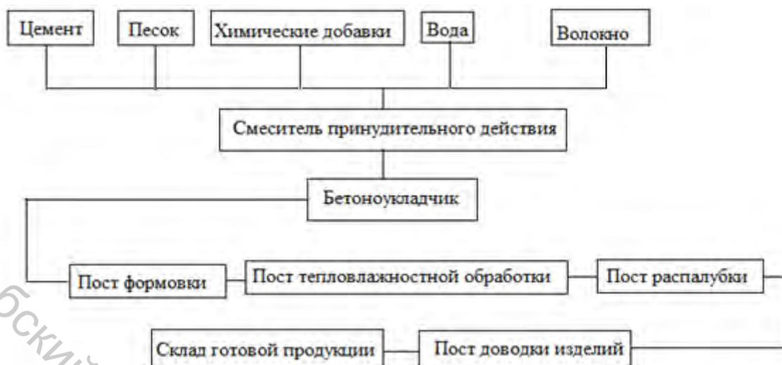
Рисунок 3.9 – Технологическая схема производства фибробетонных изделий с использованием текстильных отходов методом предварительного перемешивания
