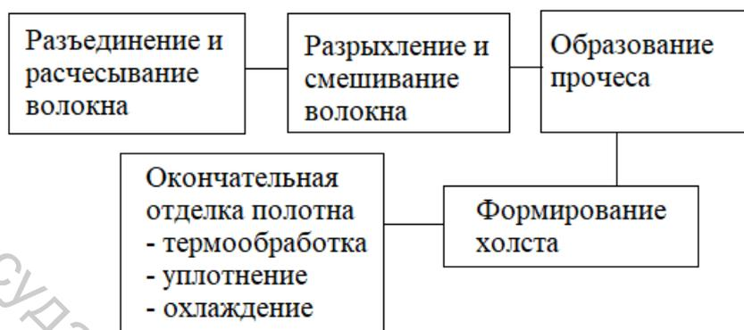
Рисунок 2.21 – Схема технологического процесса производства нетканого материала иглопробивным способом
