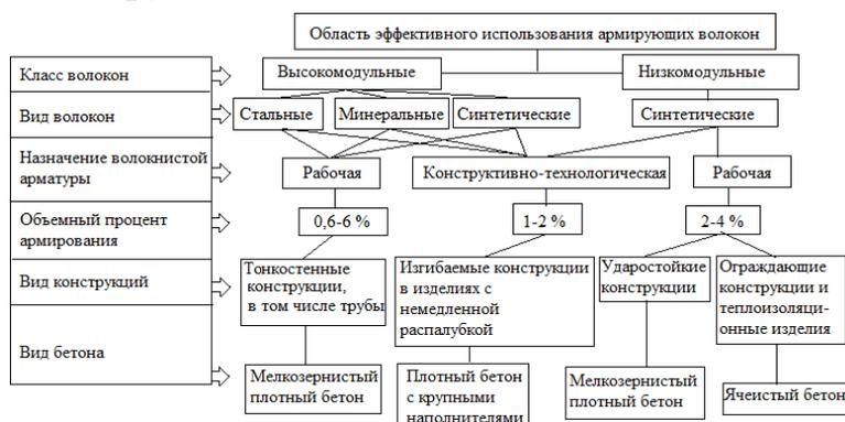
Рисунок 3.3 – Области эффективного использования различных видов волокон для фибрового армирования конструкций
