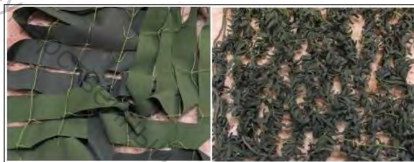
Рисунок 11.1 – Различные варианты комплектов, маскирующих от средств визуальной и радиолокационной разведок, изготовленных на основе металлизированных тканей, произведенных ООО «Ивтехномаш»
