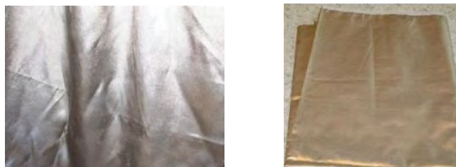
Рисунок 11.2 – Полиэфирная ткань, металлизирована серебром
