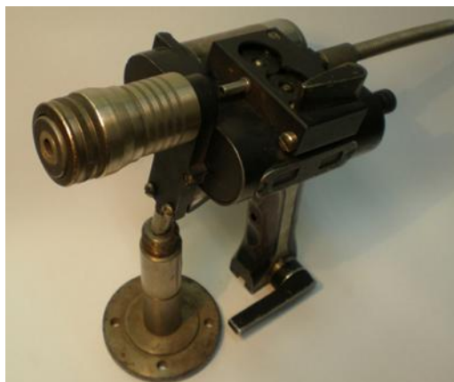
Рисунок 5 - Термораспылитель установки ТЕРКО-2
