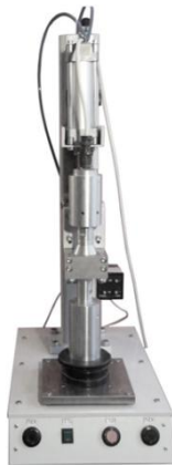
Оборудование для сварки рабочих колес погружных насосов
