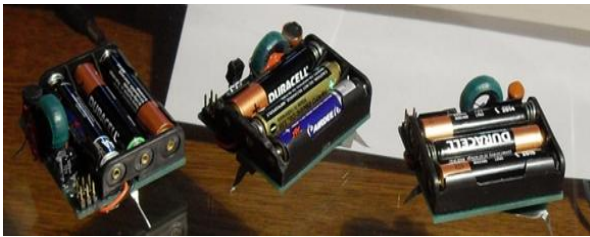
Ультразвуковые микроприводы, работающие в режиме управляемого резонанса с управляемой геометрией приводных элементов микроробота на основе сплава с эффектом памяти формы
