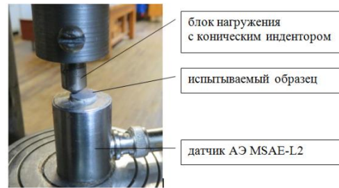
Рисунок 3 - Внешний вид нагружающего устройства акустической установки
