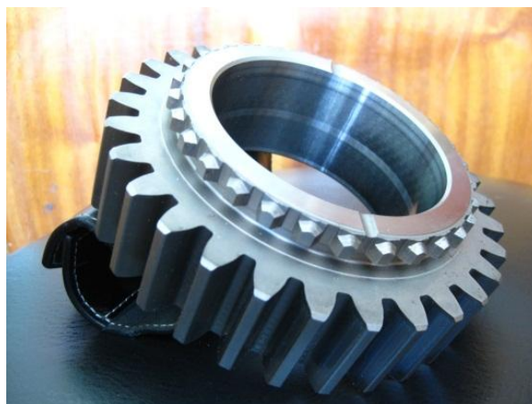
Рисунок 2 – Шестерня опытно-промышленной стали после стендовых испытаний
