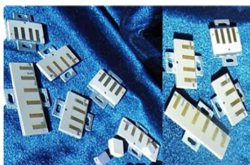
а б в Рисунок 4 - Варианты реализации ППФ из керамики на основе системы x\text{LaAlO}_3-(1-x)\text{CaTiO}_3 : а – полосковые фильтры; б – на диэлектрических резонаторах; в – на двухрезонаторных моноблоках.
