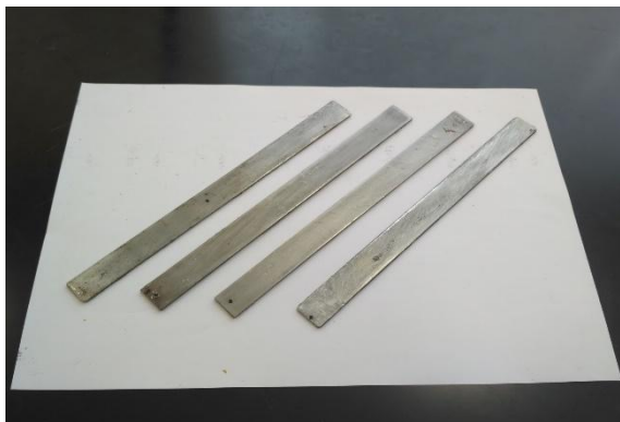
Рисунок 1 - Пластины с покрытиями, подготовленные к нанесению полосы проводящего слоя
