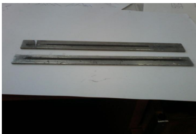
Рисунок 2 - Окончательный вид пластины с пленочным нагревательным элементом
