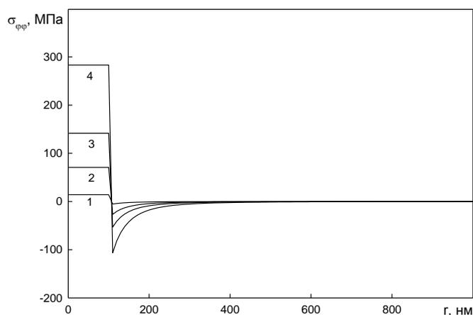
Рисунок 2 - Радиальное распределение касательных напряжений в частице и матрице для различных значений перепада температуры: 1 –  $\Delta T = 10\text{К}$ , 2 – 50, 3 – 100, 4 – 200
