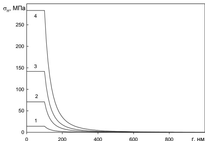
Рисунок 1 - Радиальное распределение нормального напряжения в частице и матрице для различных значений перепада температуры: 1 –  $\Delta T = 10\text{К}$ , 2 – 50, 3 – 100, 4 – 200
