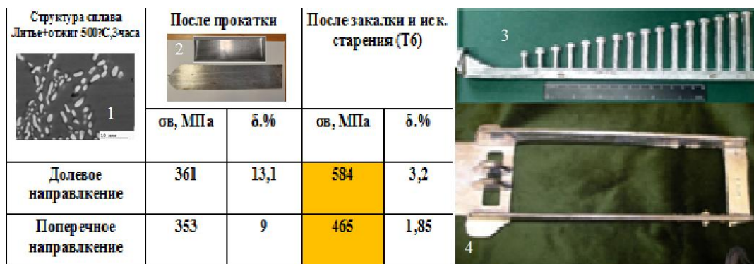
Рисунок 2 - Структура и свойства высокопрочного сплава Al-10%Zn-3%Mg-3,5%Ca: 1- микроструктура после литья и отжига при 500°C в течение 3-х часов; 2- вид листового проката; 3- проба на горячеломкость «карфа»; 4 - отливка «педаля ножного насоса»
