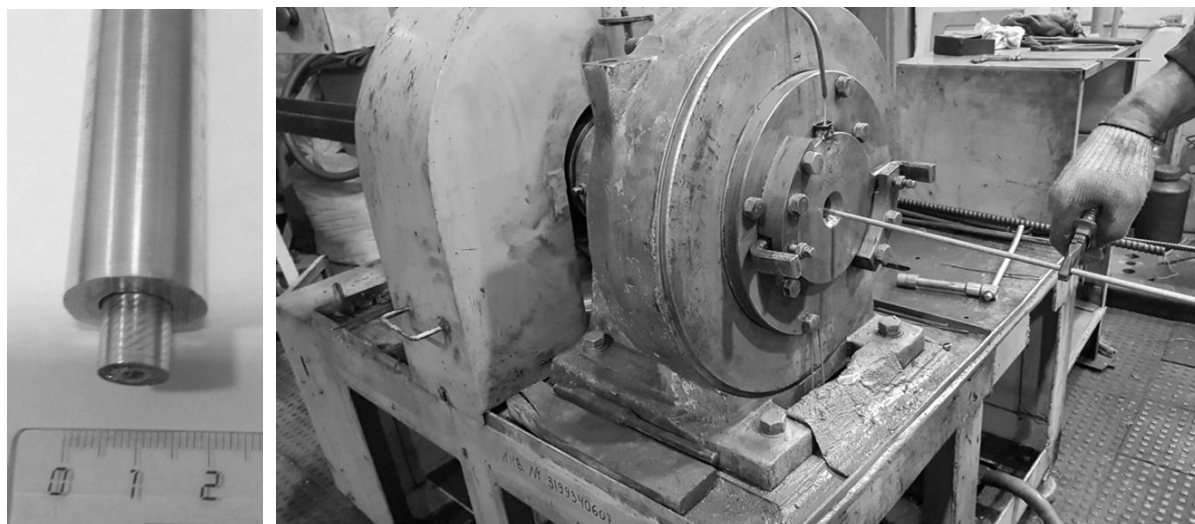
Рисунок 1 - Биметаллическая заготовка «алюминиевый сплав / медь» (слева) и процесс ротационнойковки (справа)
