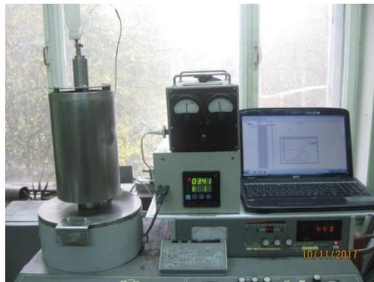
Рисунок 2 - Установка дегазации
