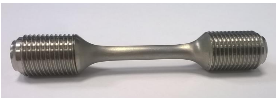
Рисунок 1 - Гладкий образец круглого сечения тип II для испытаний на МЦУ
