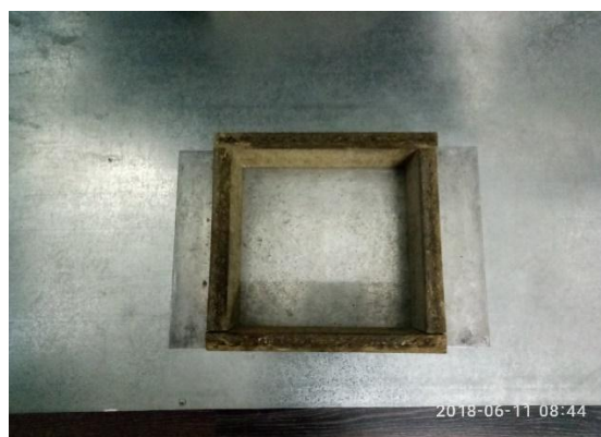
Рисунок 2 – Форма для формирования плиты 270x270
