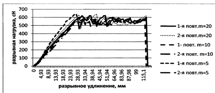
Рисунок 1 – Кривые растяжения комбинированной высокоусадочной нити при разном предварительном натяжении
