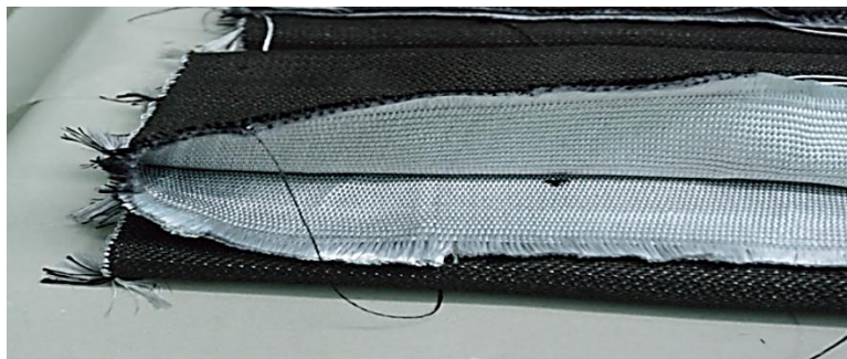
Рисунок 2 – Тканая заготовка из углеродных и кварцевых нитей
