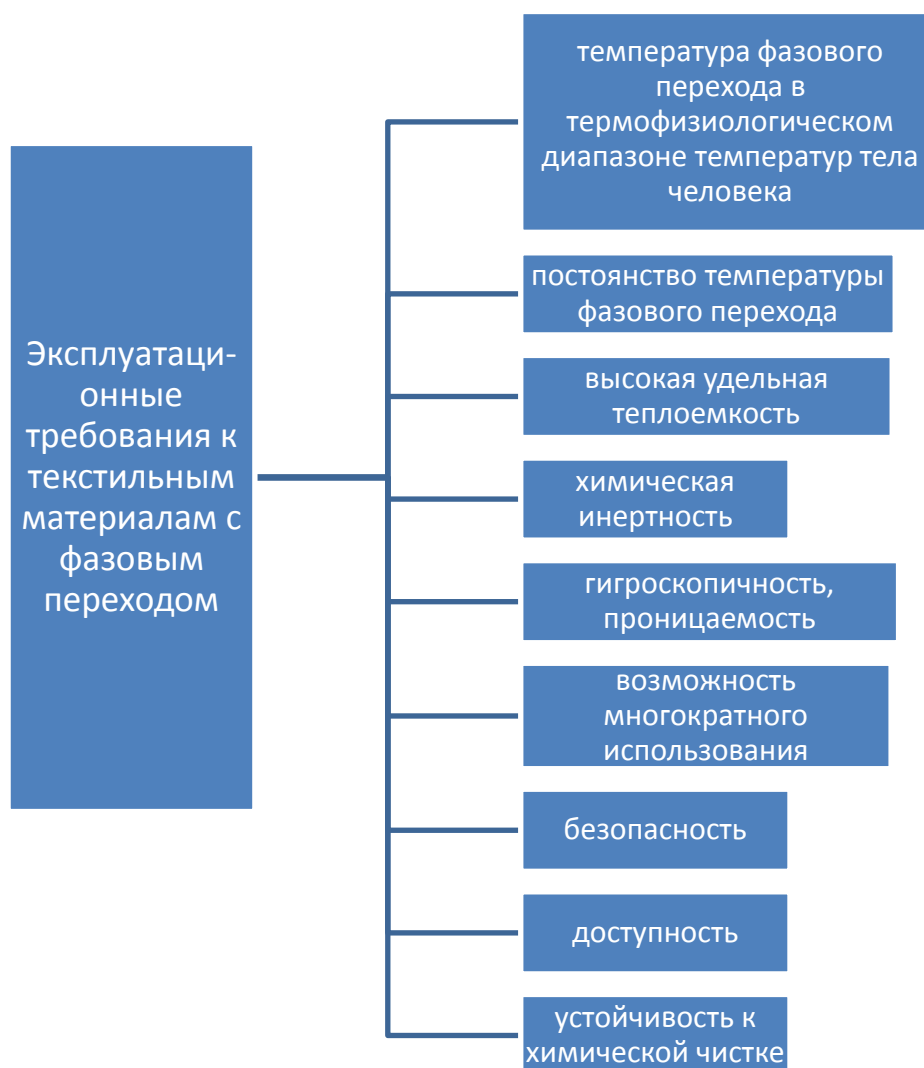
Рисунок 1 – Эксплуатационные требования к текстильным материалам с фазовым переходом, применяемым в боевой одежде пожарного
