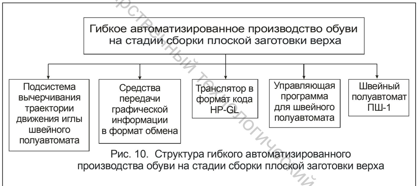
Новая система автоматизированного проектирования реализуется из отдельных элементов существующих САПР посредством организации между ними необходимых связей с помощью файла обмена графической информации (dxf- формат), что обеспечивает высокую степень автоматизации проектирования, исключает трудоемкое ручное информационное согласование данных и позволяет интегрировать предложенную САПР в любую действующую как полностью, так и частично.
