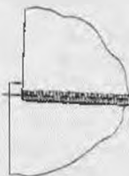
Рисунок 1 - Накладной шов с открытым срезом, предварительно обметанным частой строчкой на машине F 27 - 00 - 1MD - 23 и 885 - 260 фирмы «Римольди»
