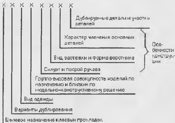
Рисунок 1 - Структурная схема классификации деталей клеевых прокладок
