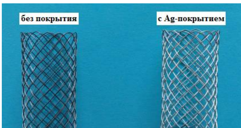
Рисунок 1 – Внешний вид проволочных TiNi стентов до и после нанесения Ag-покрытия
