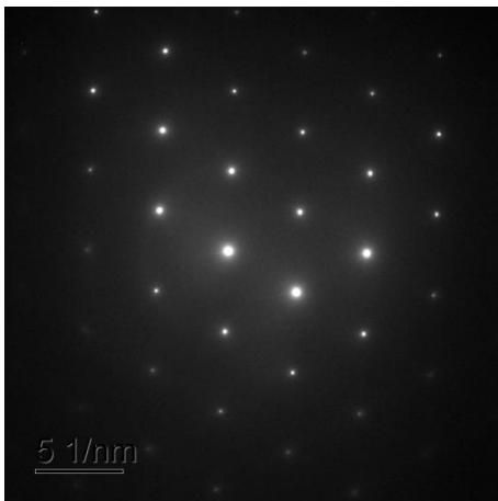
Рисунок 7 – Микродифракция от области 2 (аустенит)
