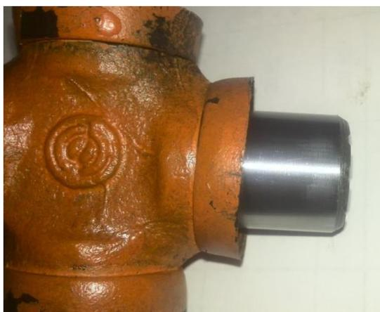
Рисунок 1 – Крестовина 53А-2201030-01 после проведения стендовых испытаний
