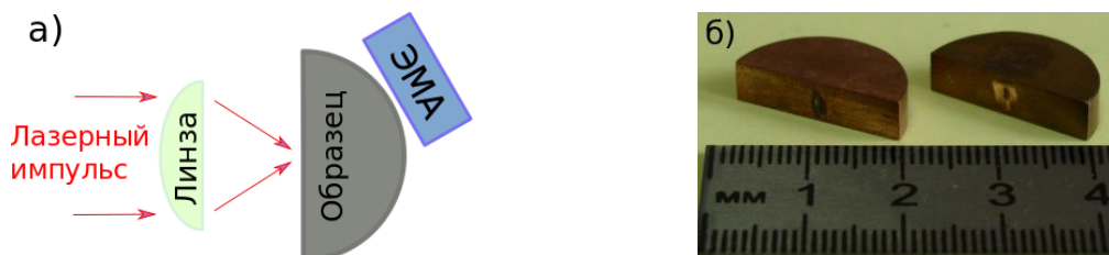
Рисунок 2 – Схема локализованного возбуждения импульсов (а). Образцы меди и бронзы (б)
