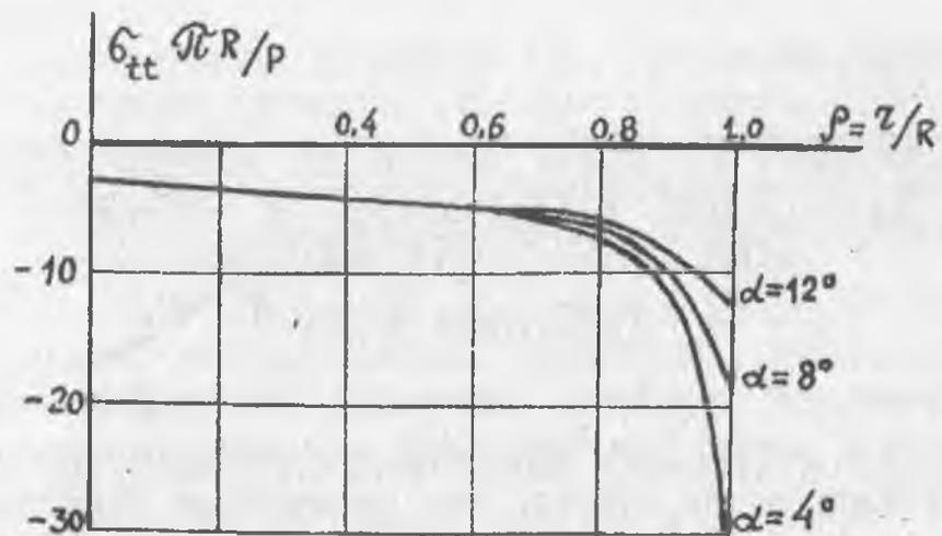
Рис. 3. Напряжения  $\sigma_{tt}$  в экваториальной плоскости.
