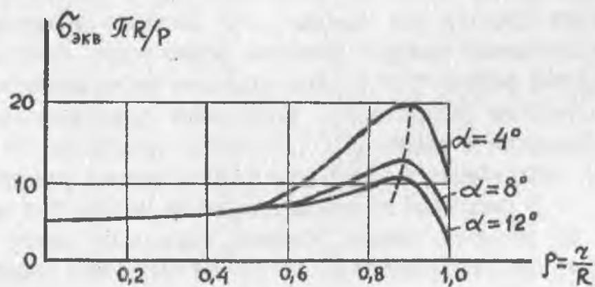
Рис. 5. Эквивалентные напряжения в экваториальной плоскости.
