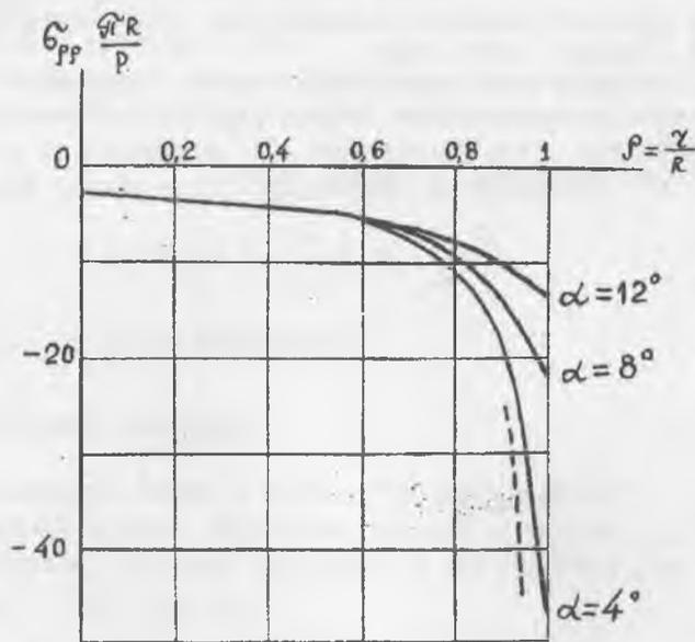
Рис. 2. Напряжения  $\sigma_{pp}$  в экваторальной плоскости.
