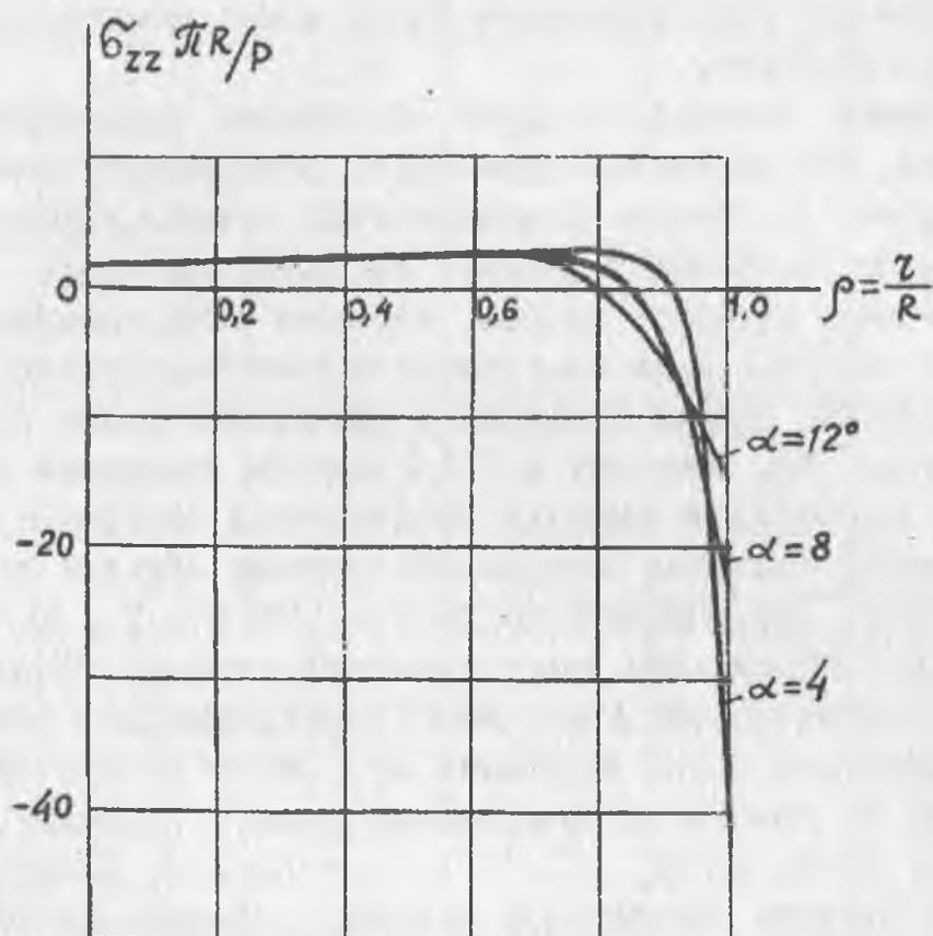
Рис. 4. Напряжения  $\sigma_{zz}$  в экваториальной плоскости.
