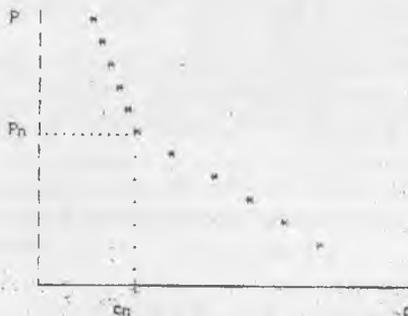
Рис. 1. Зависимость давления прессования от содержания пластификатора при экструзии.
