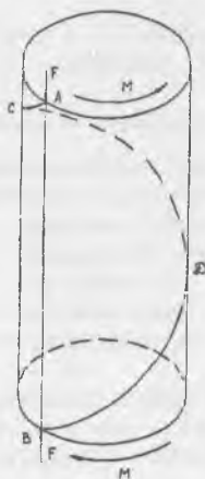
Рис. 1. Схема нагружения стержня крутящим моментом M и сжимающей силой F .
